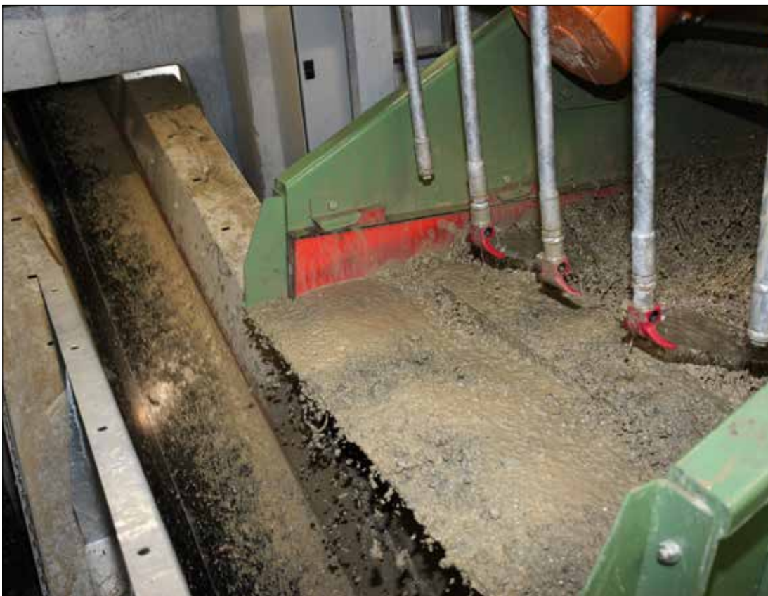
Das vom Schlamm getrennte Grobmaterial wird durch ein Förderband ausgetragen.
